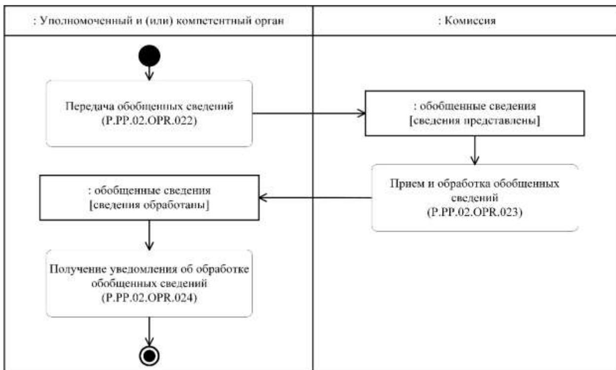
Рис. 12. Схема выполнения процедуры «Представление обобщенных сведений» (P.PP.02.PRC.008)
